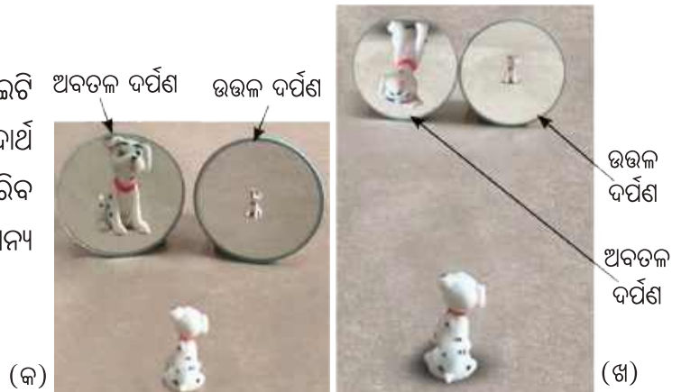
ଚିତ୍ର ୧୦.୩ ଏକ ଉତ୍ତଳ ଓ ଅବତଳ ଦର୍ପଣ ସମ୍ମୁଖରେ ରଖା ଯାଇଥିବା ଏକ ବସ୍ତୁ (କ) ସ୍ୱଳ୍ପ ଦୂରତାରେ (ଖ) ଅଧିକ ଦୂରତାରେ
